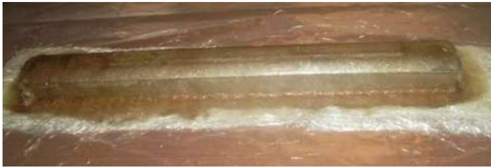
Figure II.10. Outil en métal recouvert en mat de verre
