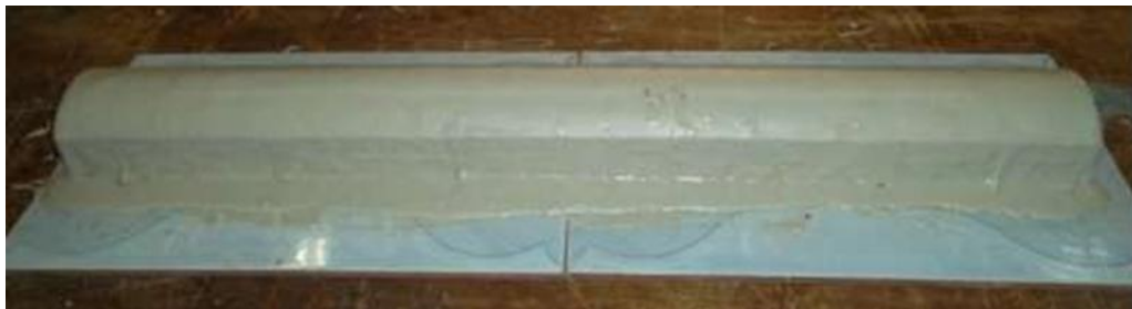
Figure II.9 Outil en métal recouvert avec la solution préparée
