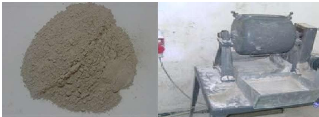
a) b) Figure II.2. Représentation du sable de dune broyé a) et broyeur à boulet b).
