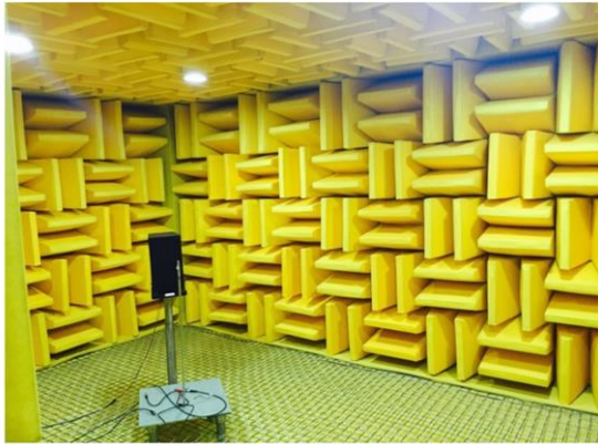
Figure II.4 : La salle anéchoïque (raykingtek.com)
