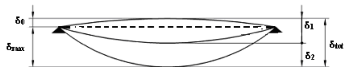
Figure 4. Déformations verticales d'une poutre bi-appuyée.
