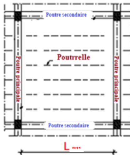
Figure 1.6 : Plancher à corps creux
