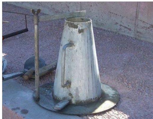
Figure V.1 : Essai d'affaissement au cône d'Abram(3)
