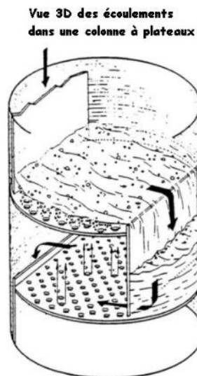
Figure IV.2 : Ecoulement du liquide dans une colonne à plateaux.
