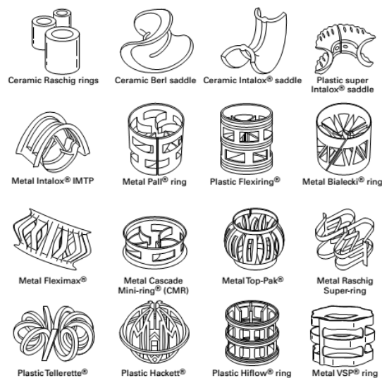
Figure II.9 : Exemple de garnissage en vrac.
