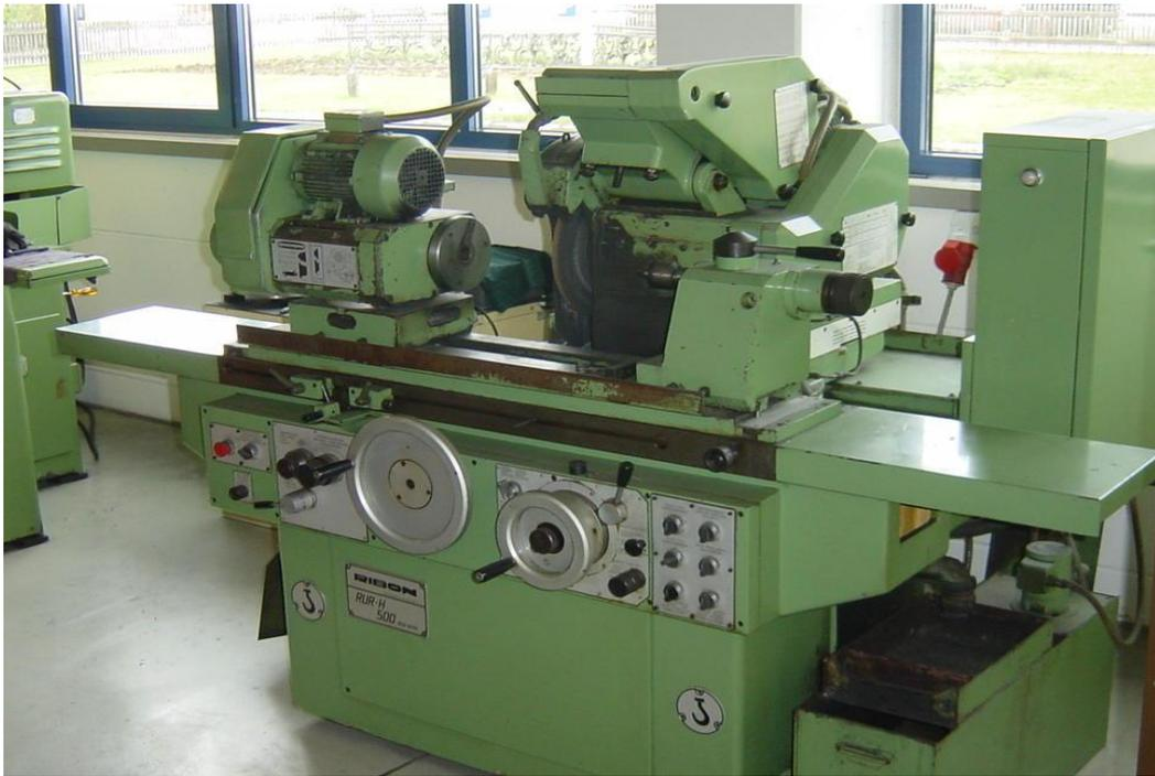
Figure II-10 : Rectifieuse cylindrique
